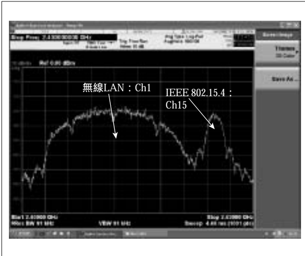
〔図9〕無線LANとの干渉を回避した様子
