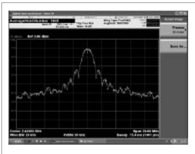
〔図5〕DSSSスペクトラム拡散波
