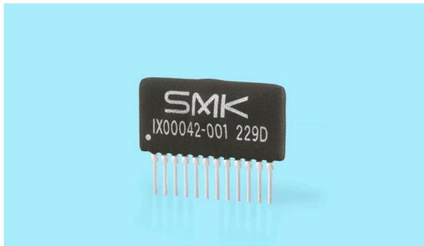
当社はこのほど、静電容量値を計測、検知可能な回路をワンパッケージ化した「静電容量検知ハイブリッド IC」を開発しました。容器の外側に電極を貼り付け、本製品とつなげることで、容器内の対象物を非接触で検知することができます。例えば、中身の液体には直接触れずに、液面があらかじめ設定したレベルに達したかを検知できるため、液体食品や医療機器等、衛生面への配慮が必要な商品の残量・満タン確認といった用途に最適です。
