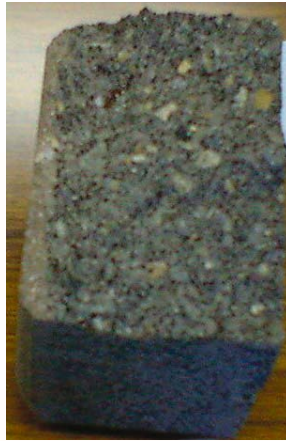
ガラス複合部材のリサイクル品(路盤材)
