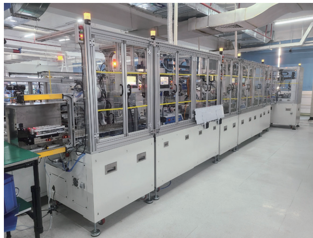
6軸ロボットを使用したリモコン組立省力機(中国・東莞工場)
