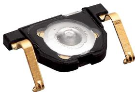
独自構造採用により“はんだレス”で実装できる小型(当社従来比15%減)のドームスイッチです。はんだ破壊の心配がなく、安定した接触信頼性を実現します。
